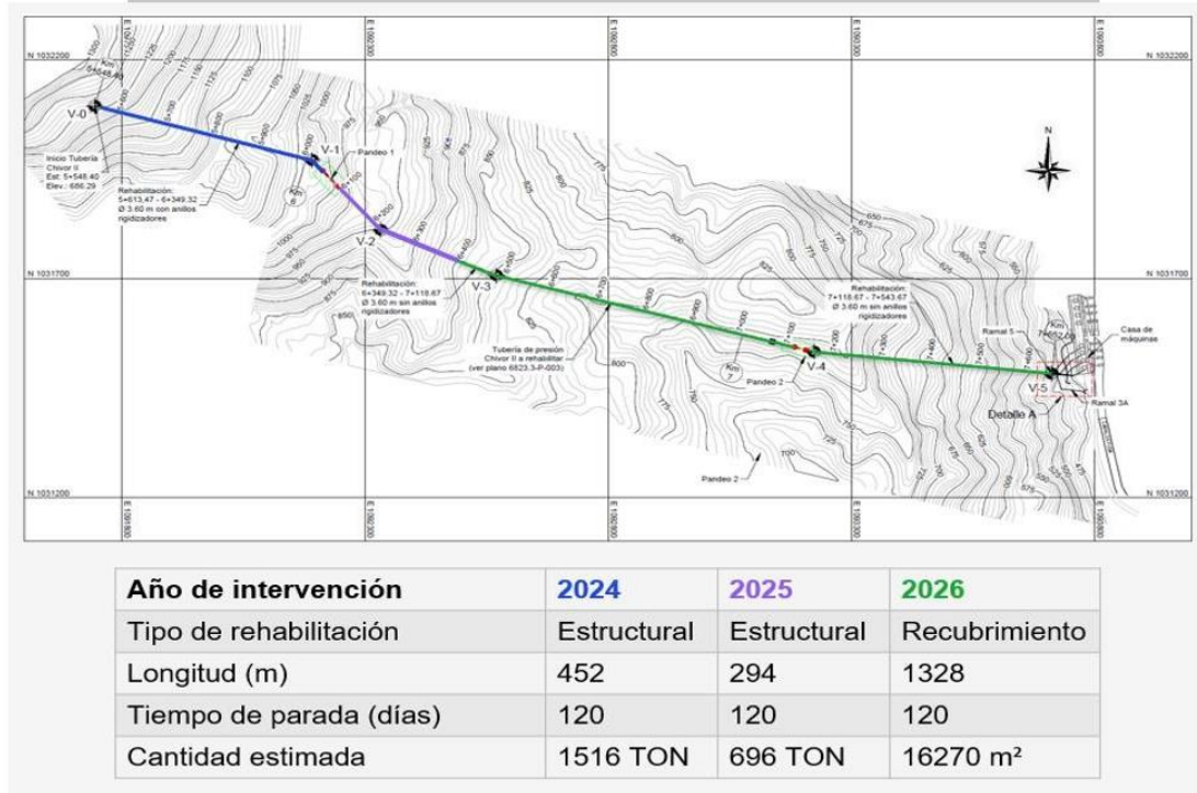
Imagen 6. Plano con secciones de mantenimiento del blindaje de la conducción de Chivor II
